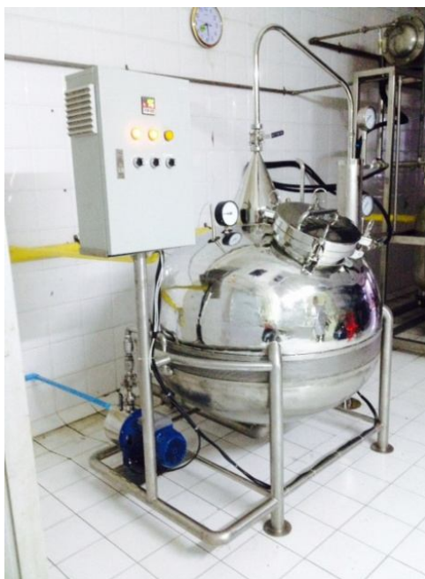
ภาพถ่ายจริงเครื่องกลั่นขนาดความจุ 200 ลิตร
