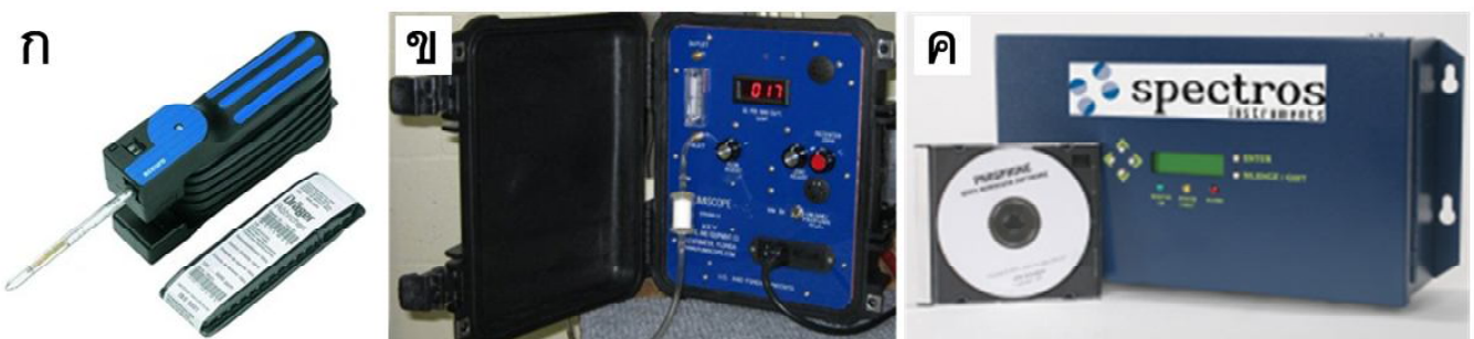
ภาพที่ 3 (ก) ปั๊มมือและหลอดวัดความเข้มข้นก๊าซ, (ข) เครื่องวัดความเข้มข้นก๊าซ fumiscope และ (ค) เครื่องวัดความเข้มข้นก๊าซ spectros instruments
