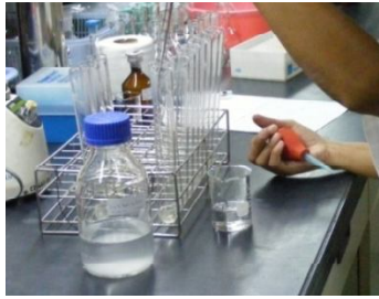
เติม 0.5 M NaOH ที่ละลายใน methanol 5 ml และ ISTD* ความเข้มข้น 2000 ppm 1 ml
