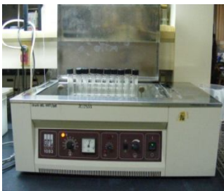
reflux ใน water bath ที่อุณหภูมิ 90 °C นาน 15 นาที
