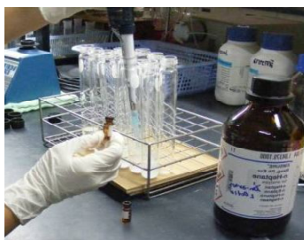
ดูดสารละลาย n-heptane ชนบน ใส่ vial 1 ml
