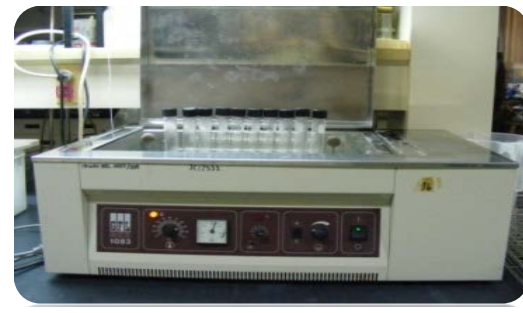
reflux ใน water bath ที่อุณหภูมิ 90 °C นาน 15 นาที
