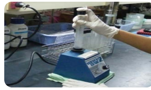
ผสมให้เข้ากันด้วยเครื่อง vortex mixer ประมาณ 1 นาที
