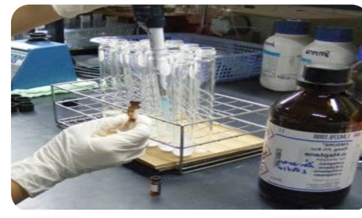
ดูดสารละลาย n-heptane ขึ้นบน ใส่ vial 1 ml
