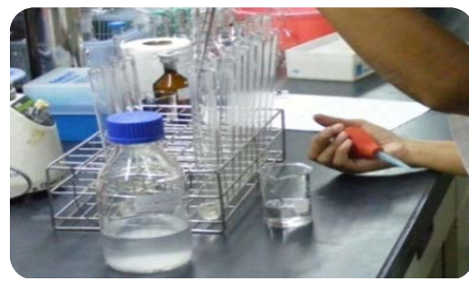
เติม 0.5 M NaOH ที่ละลายใน methanol 5 ml และ ISTD* ความเข้มข้น 2000 ppm 1 ml ISTD* (internal standard; heptadecanoic acid: C_{17}H_{33}COOH ; Sigma)
